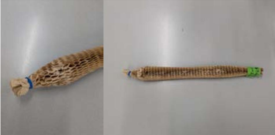
60cm落下後のワイン瓶(L)の緩衝材。角落ち時、多少の潰れや破れが生じている。
