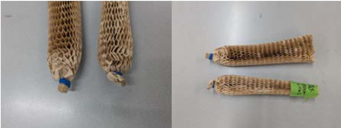
テスト後の小瓶(S)の緩衝材。梱包物重量が軽いため、破損が少ない。
